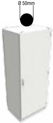
50 mm den büyük cisimlere karşı koruma (rastlantısal elle dokunma)
